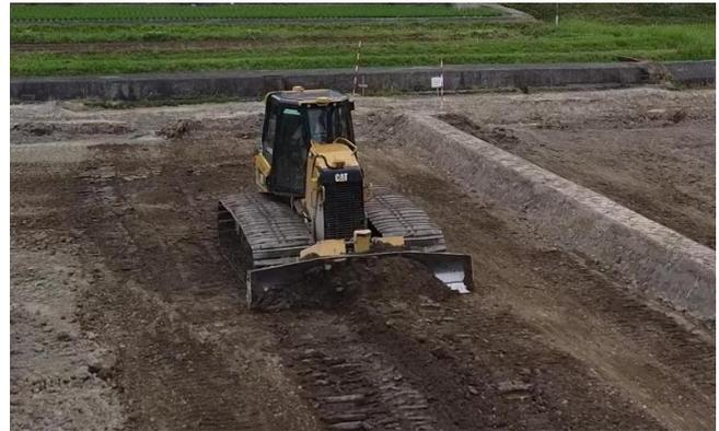
図-6 マシンコントロールブルドーザー
