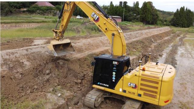
図-11 チルトバケットを装着したバックホウ
