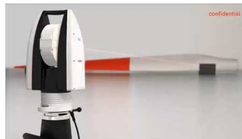
ダイレクトポイント計測
