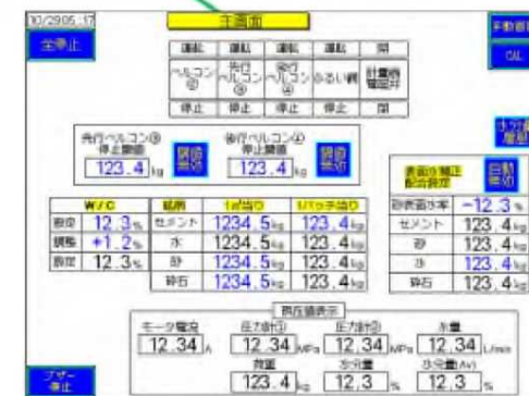
計量器盤モニター
