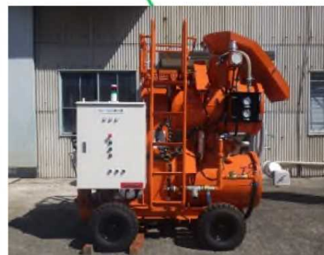
吹付機・制御盤
