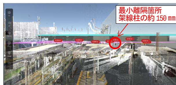
図-11 橋りょう架設時の電停設備との離隔確認
