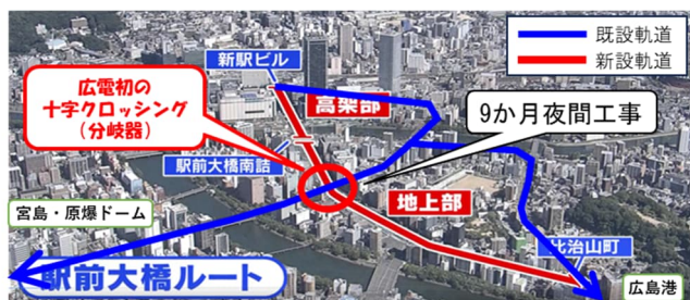
図-13 駅前大橋ルート of 軌道工事概要図
