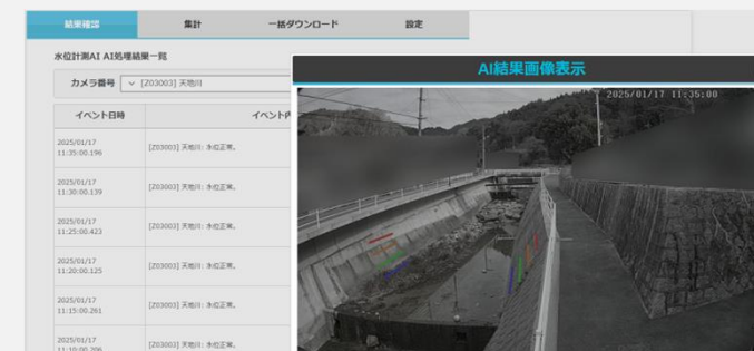
水位検知状況確認画面
