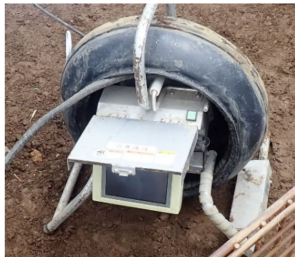
ボアホールカメラ (モニター)
