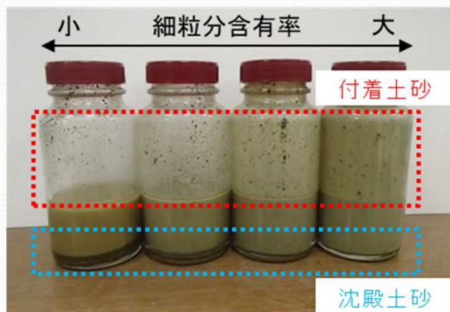
撮影対象とした解泥土砂 (土粒子質量 m_s=50g , 含水比 w=150\% )
