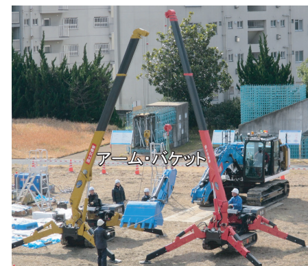
小型式クローラークレーンの共吊りによる組立作業
