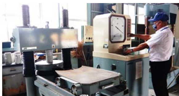
圧縮強度試験
