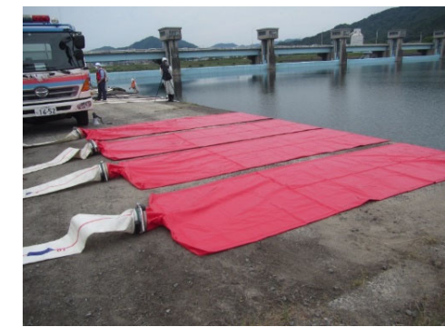
標準排水ホースと拡幅型排水ホースの接続状況
