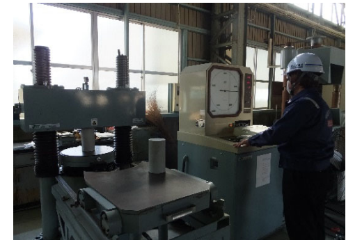
圧縮強度試験
