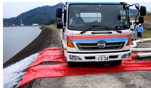
大型車両による500回程度の走行において耐久性に問題無いことを確認
