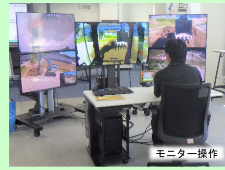
バックホウ・遠隔操縦装置訓練【協定会社等】
