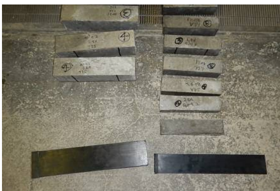
JIS規格の供試体（左） 小型化した供試体（右）
