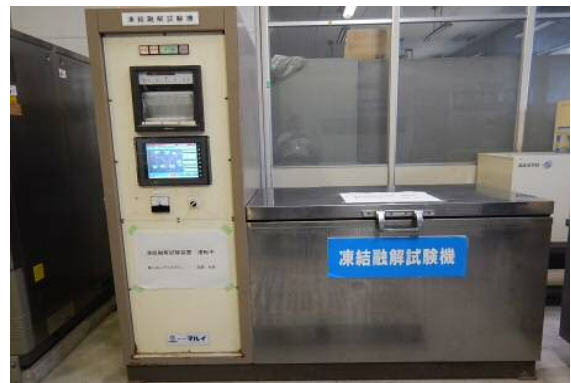
凍結融解を繰り返し調査する 凍結融解試験機
