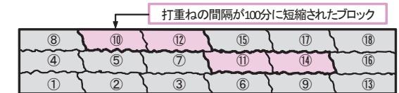
図 コールドジョイントの発生を抑制する方法の例
