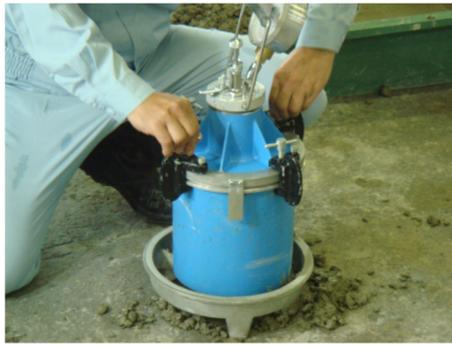
④上蓋を静かに乗せ、4点のネジを対角に閉め込む。この時、上蓋の全てのバルブは開放しておく。
