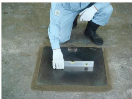
①水密性平板は安定した場所に設置し、水準器により水平を確認する。
