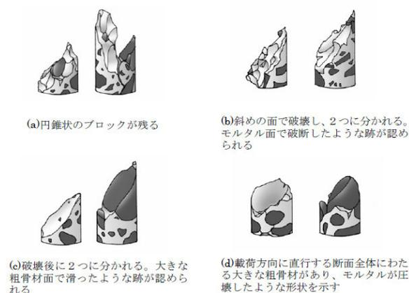
図 12-8 コアの破壊形状パターン図
