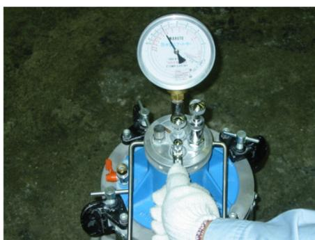
⑥約5秒後に作動弁を開き、容器の側面を木づちでたたく。再度作動弁を開き、指針が安定してから圧力計の目盛りを0.1単位で読む。
