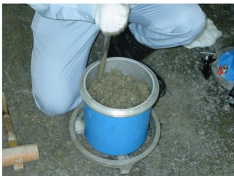
①下容器を水平台の上にセットし、試料を3層に分け、突き棒で各層25回突く。突き深さは前層に届く程度とする。
