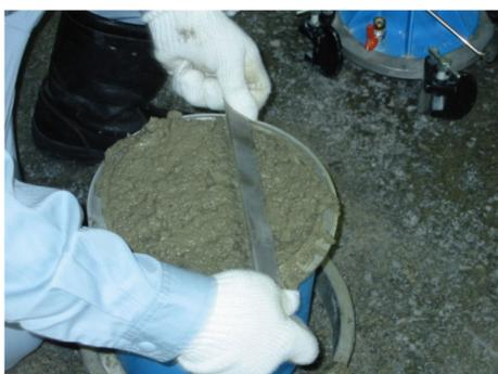
③3層目の動作が終了した後、容器の上面を均し定規で平坦に均し、上蓋との接地面を布等で拭き取る。
