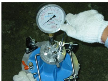
⑤ハンドポンプにより空気室に圧力を加え、初圧力よりわずかに大きくする。約5秒後に調節弁を徐々に開き、圧力計を軽くたたきながら初圧力の目盛りに一致させる。
