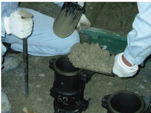
① 突き棒を用いる場合は、2層のほぼ等しい層に分けて詰める。ダムコンクリート等のスランプが低い場合で、内部振動機を用いる場合も同様。
