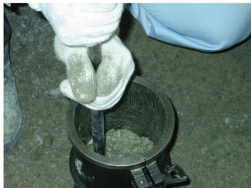
② 型枠底面積の  $1000\text{ mm}^2$  に1回の割合で、すぐ下の層まで突き棒が届くように突く。内部振動機を用いる場合は、すぐ下の層に  $20\text{ mm}$  程度差し込むようにする。
