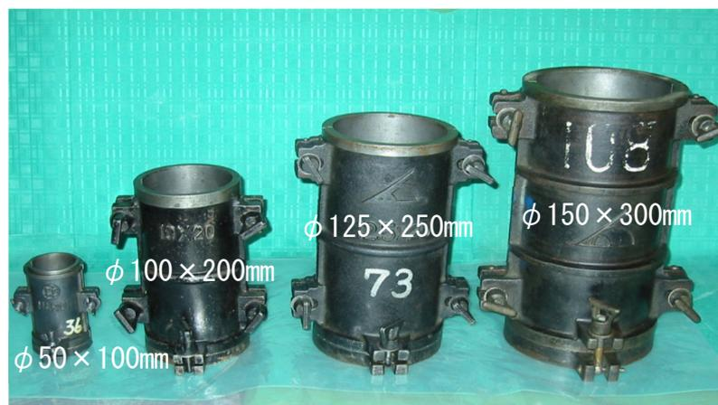
写真 6-6 型枠の種類(一例)
