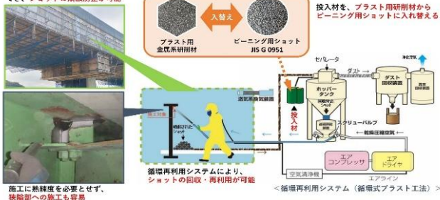
循環式ショットピーニング工法システム図
