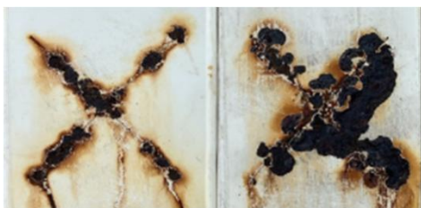
さび鋼板上での塗膜防食試験結果 (CCT800サイクル) 左：ダンジオーラE下塗 60μm×2回 右：従来技術60μm×2回 ※カット部からの腐食進行度が従来技術の約1/3
