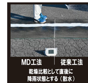
MD工法 従来工法 超速乾 1~2分後の乾燥性比較
