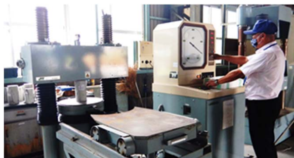
圧縮強度試験
