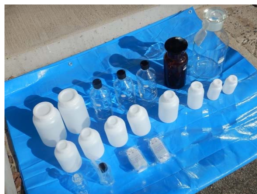
【関係各事務所に配布している水質事故の際に必要な採水容器】
