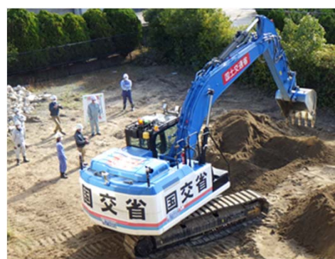
分解組立型バックホウ・遠隔操作説明会（R2.11） 見学者：中国地方整備局管内施工業者他
