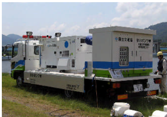
排水ポンプ車
