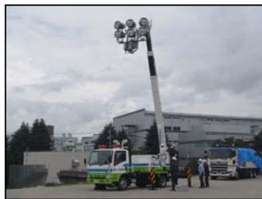
照明車 (2kW×6灯)
