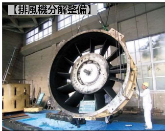
【排風機分解整備】
