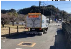
(空洞探査車による調査)
