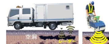
路面下空洞調査
