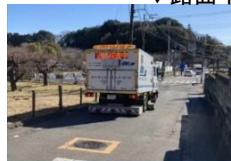
(空洞探査車による調査)
