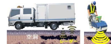
路面下空洞調査
