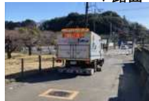
(空洞探査車による調査)
