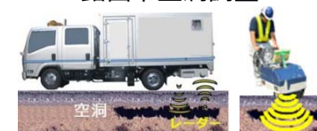
路面下空洞調査
