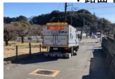
(空洞探査車による調査)
