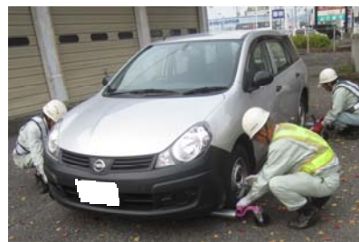
車両移動用機械設置
