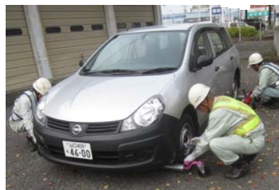
車両移動用機械設置
