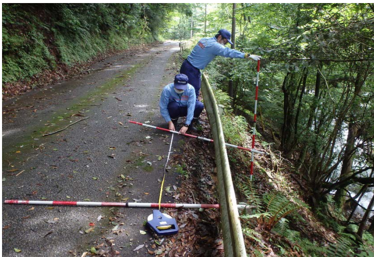
路肩陥没被災箇所の現地調査（熊本県人吉市）
