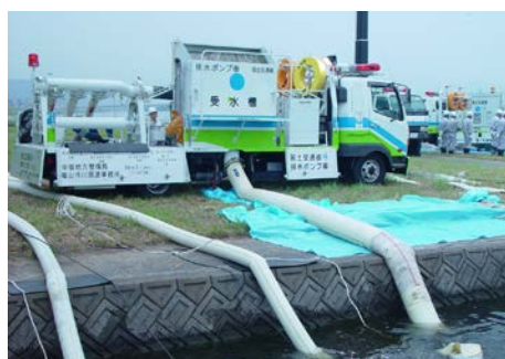
写真 5-2-30 排水ポンプ車
