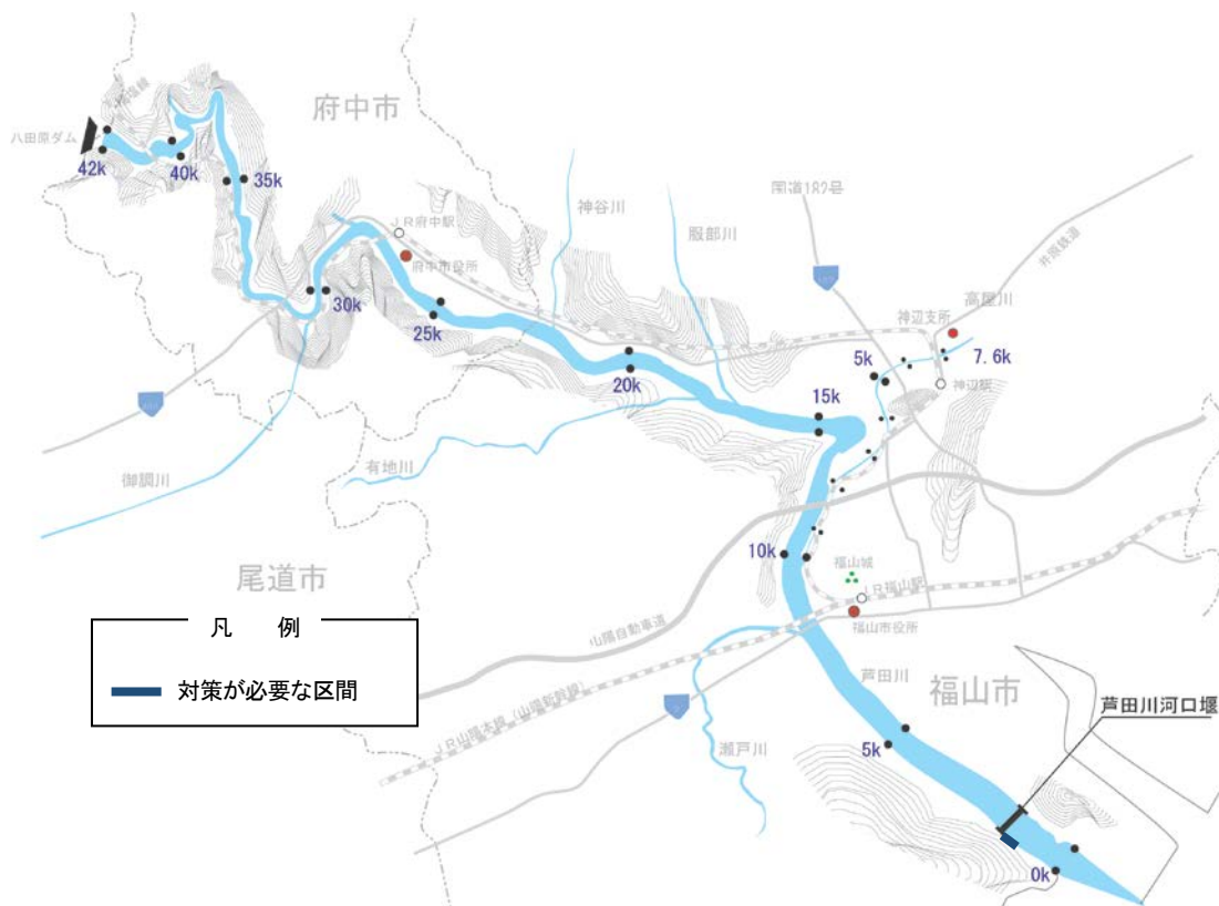
図 2-1-5 堤防の耐震対策必要箇所
