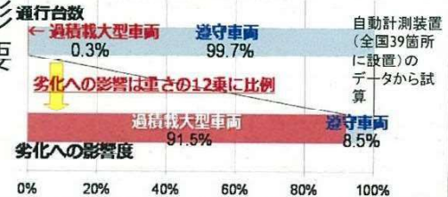
【図 道路橋の劣化に与える影響】
