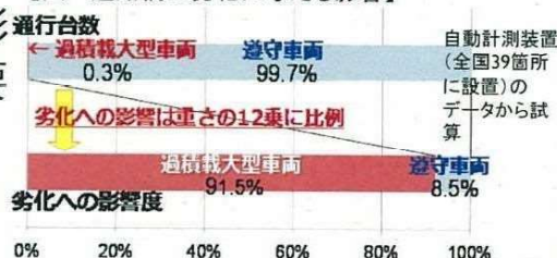
【図 道路橋の劣化に与える影響】
