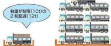
仮に、大型車両1台が、軸重10トンの基準より2割超過した場合は、舗装に対しては約2台分、RC床版に対しては約9台分の疲労が蓄積されることとなります。
