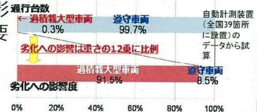
【図 道路橋の劣化に与える影響】
