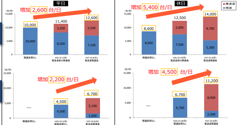
▲尾道松江線と現道の主要断面の交通量推移
