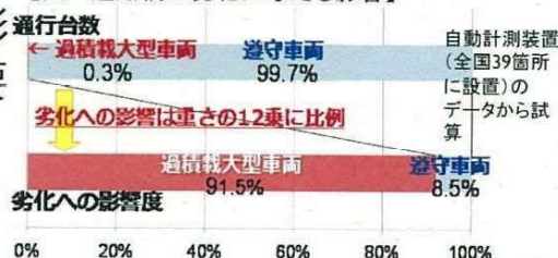
【図 道路橋の劣化に与える影響】
