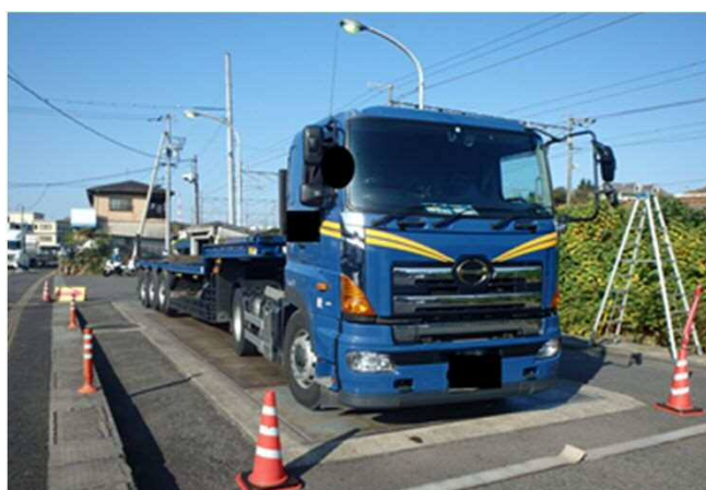
車両重量計測
