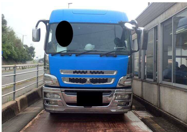
車両重量計測
