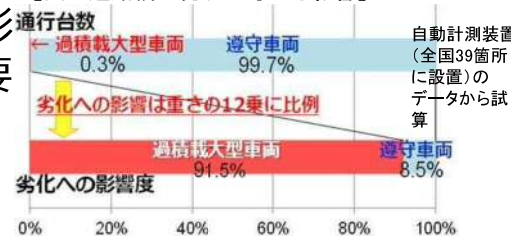
【図 道路橋の劣化に与える影響】
