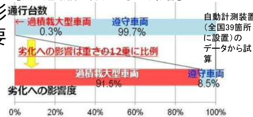
【図 道路橋の劣化に与える影響】
