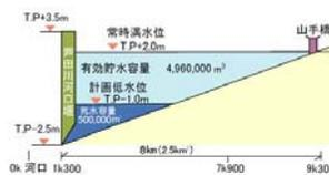
図 1-2-4 芦田川河口堰貯水容量図
