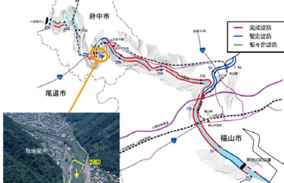
図 2-1-3 堤防整備状況平面図
