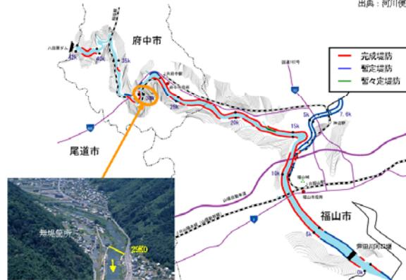
図 2-1-3 堤防整備状況平面図
