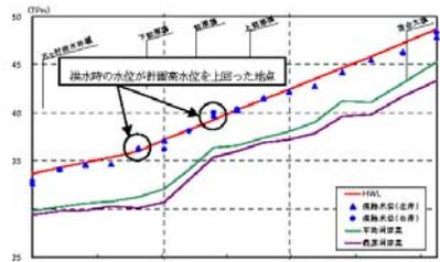
図 2-1-2 平成 10 年 10 月洪水の痕跡水位縦断面図（目撃地点（府中上流））
