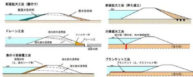
図 5-1-7 堤防強化対策工法イメージ図（各種対策工法）
