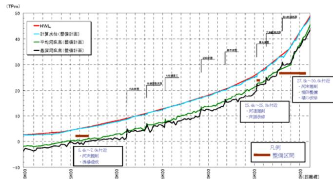
図 5-1-6 水位低下対策実施後の水位縦断面（芦田川本川）
