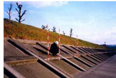
写真 5-2-5 洪水痕跡調査
