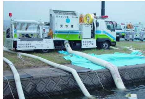
写真 5-2-30 排水ポンプ車
