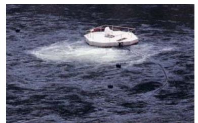
写真 5-1-10 躍層低下循環施設
