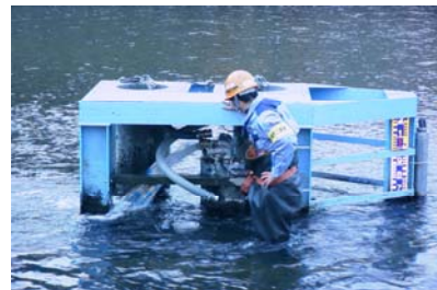
写真 5-2-24 水質観測装置の点検状況
