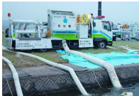
写真 5-2-30 排水ポンプ車
