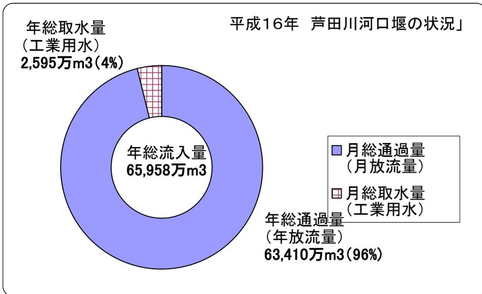
平成16年の芦田川河口堰の年間総流入量は65,958万m<sup>3</sup>で、その内、工業用水として2,595万m<sup>3</sup>を取水し、残りの63,410万m<sup>3</sup>を河口に流しています。
