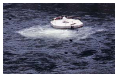
写真 5-1-10 躍層低下循環装置
