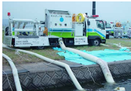
写真 5-2-30 排水ポンプ車
