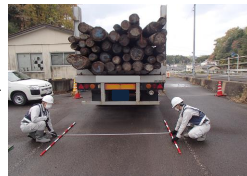
車両重量計測・寸法計測(幅)
