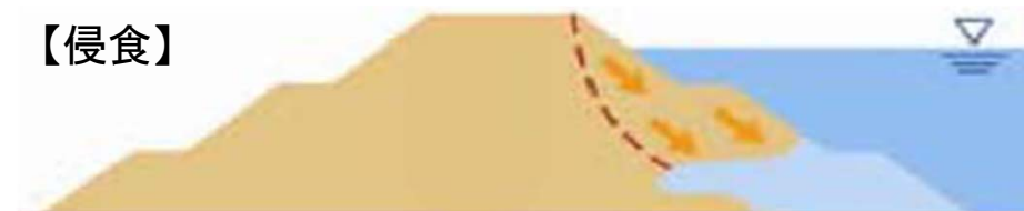
漏水、侵食による堤防の決壊過程
