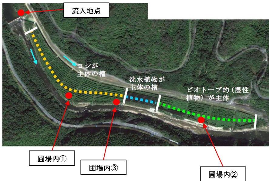
【植生浄化施設 水質調査地点】
