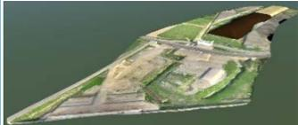
3次元測量点群データと設計図面との差分から、施工量を自動算出
