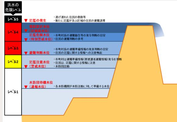
水位標示については、危険度を5段階で設定し川の状況や危険レベルがイメージしやすいような用語にしています。危険度に合わせて市町村に、气象台と合同で「氾濫注意情報」「氾濫警戒情報」「氾濫危険情報」「氾濫発生情報」として提供していきます。また、住民のみならずわかりやすい言葉で情報提供します。また、河川の護岸や橋梁を利用して、危険度を示す水位標示をしています。洪水予報等水位情報の発表については、日野川本川では車尾、溝口観測所、法勝寺川では福市観測所の水位を基に発表します。
