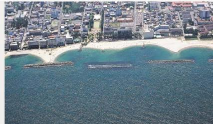
●写真中央の構造物がクレスト型人工リーフ
