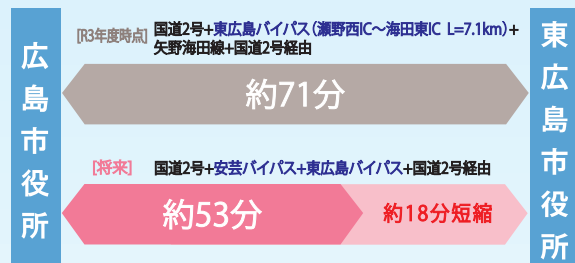
R3年度時点:H27道路交通センサス混雑時旅行速度より算出 将来:東広島バイパス・安芸バイパスをV=70km/h,その他H27道路交通センサス混雑時旅行速度より算出
