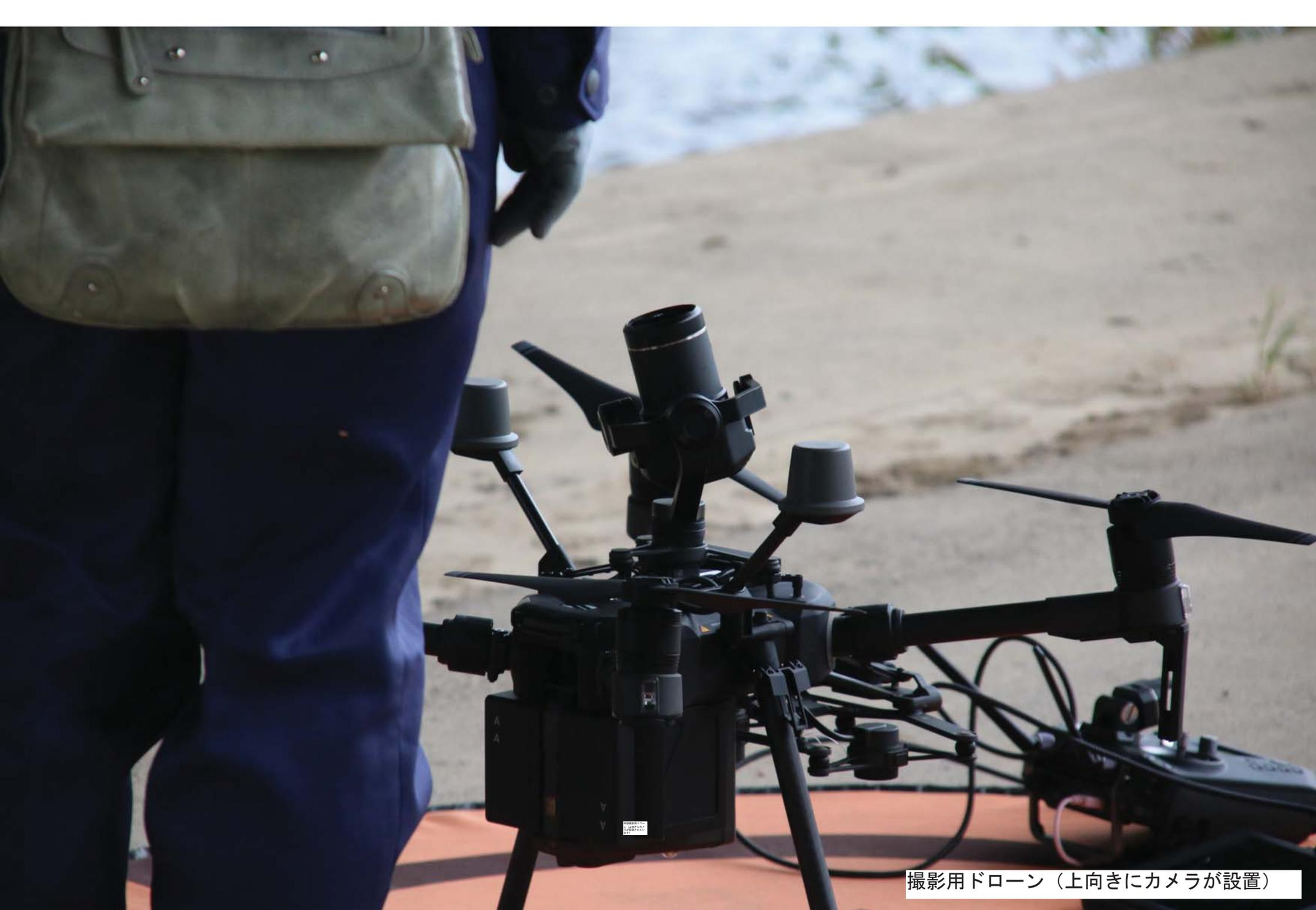
撮影用ドローン（上向きにカメラが設置）
